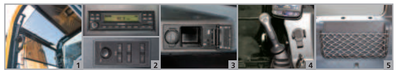
1. Aufrollbare Sonnenblende 2. Radio / MP3-Spieler mit Fernbedienung 3. Freisprecheinrichtung für Mobiltelefon 4. Ergonomische Joysticks 5. Aufbewahrungsfächer
