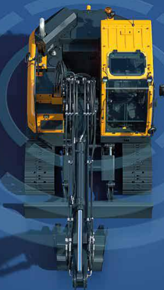
Sicheres Sichtfeld in alle Richtungen durch zehn Ansichten, einschließlich 3D-Vogelperspektive und 2D/4CH-Ansicht.
